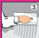
**3** Перед началом работы клей тщательно перемешайте. Нанесите клей шпателем или кистью на основание слоем от 0,5 до 1 мм. В случае значительных неровностей поверхности не рекомендуется наносить слой более 2 мм.
