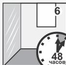
**6** Работы проводить при температуре воздуха и основания от +5 до +30°C и относительной влажности воздуха не более 75%. Рекомендуемая влажность основания не более 10%.
